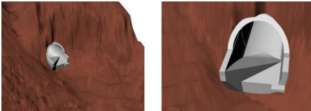
Figure 15 : Vues 3D de la cuillère de dissipation
