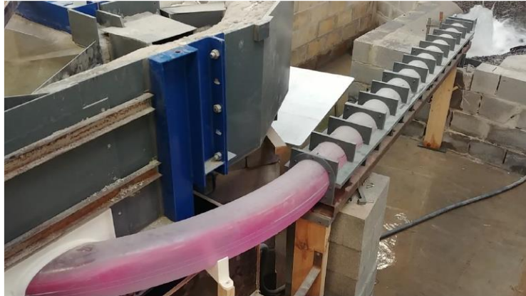
Figure 39 : Photo de la nouvelle galerie sur modèle réduit – crue de projet
