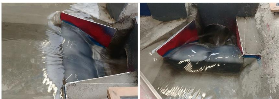
Figure 33 : Photographies du modèle réduit hydraulique du seuil en déversement
