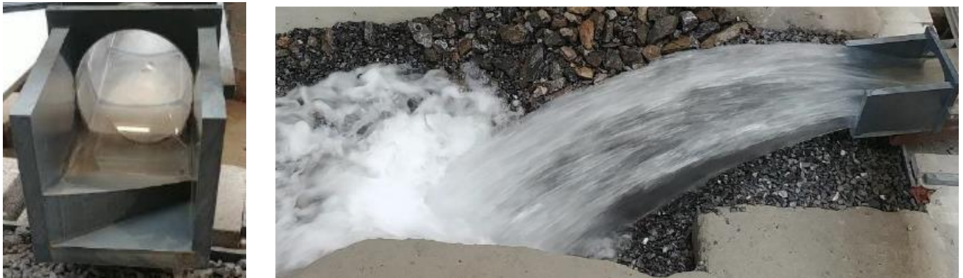
Figure 15 : Vues du saut de ski sur modèle réduit (droite : jet avec dissipation d'énergie à la crue de projet)
