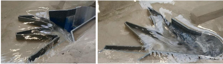
Figure 36 : Photographies du modèle réduit hydraulique de l'auge hors d'eau et en déversement
