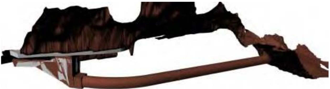
Figure 39 : Photo de la nouvelle galerie sur modèle réduit – crue de projet
